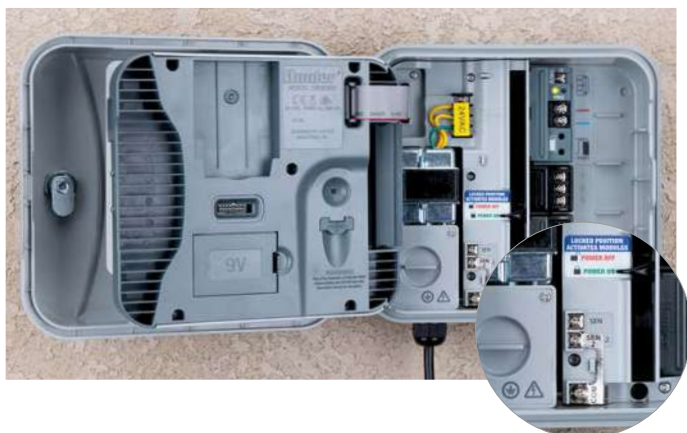
PROGRAMADOR P2C-400 CON ENTRADAS PARA 2 SENSORES
